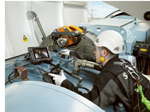
Abbildung 1: Ein Blick in das Getriebe Für Prüfer von Getrieben bieten Videokope eine schnelle und effiziente Methode zur Fehlererkennung.
